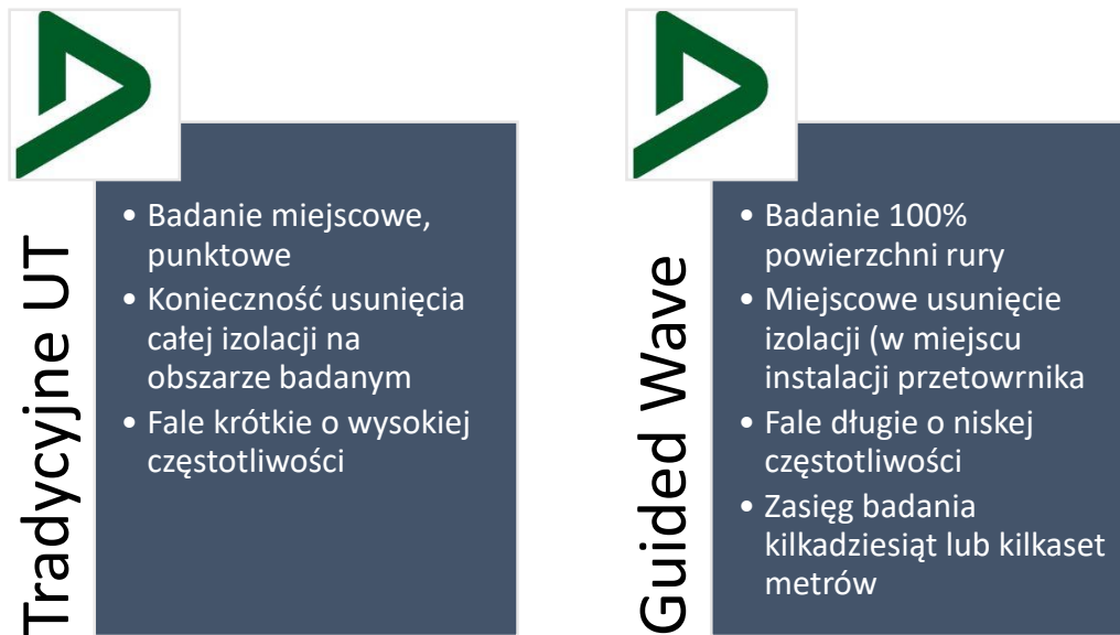
Rysunek 1 Porównanie tradycyjnego badania UT oraz techniki Guided Wave.
